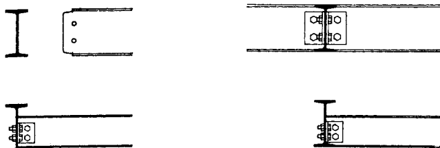
samling af bjælker ved udveksling, eksempler, mål 1:20
